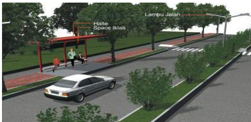
Gambar 5 Contoh Prototipe Tata Letak Halte Pada Ruas Jalan
