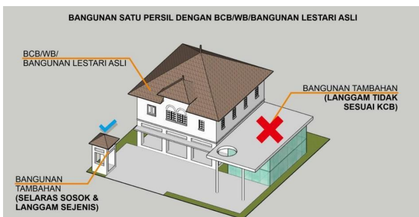
Gambar 22 Ilustrasi pengembangan bangunan satu persil dengan BCB/WB/Bangunan Lestari Asli yang salah karena langgam yang tidak sesuai karakter KCB.
